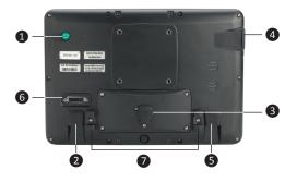
**Remarque** : veillez à ce que le câble soit bien attaché dans l'attache-câble qui se trouve à côté du port à l'arrière de la console. Ceci empêche que le câble se détache du port et réduit la pression exercée sur le câble.
